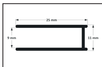
Profil zamykający drzwi
